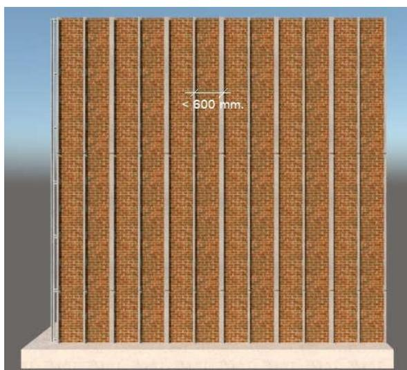
Instalar el chasis de la fachada sobre la pared, con una distancia entre los soportes no superior a 600 mm. (Ver la sección de acero aconsejada en la tabla a continuación de cada tipo de altura).
